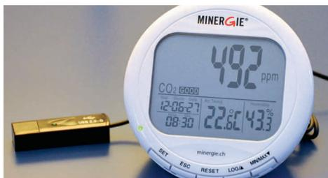
Das CO<sub>2</sub>-Messgerät misst die Luftqualität und die Temperatur.
